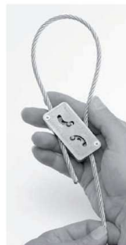
Krok 5 Do ustawiania długości, linka nie może być napięta. Nieznacznie przesunij szpilkę między ząbkami zwolnisz w ten sposób linkę z blokady
